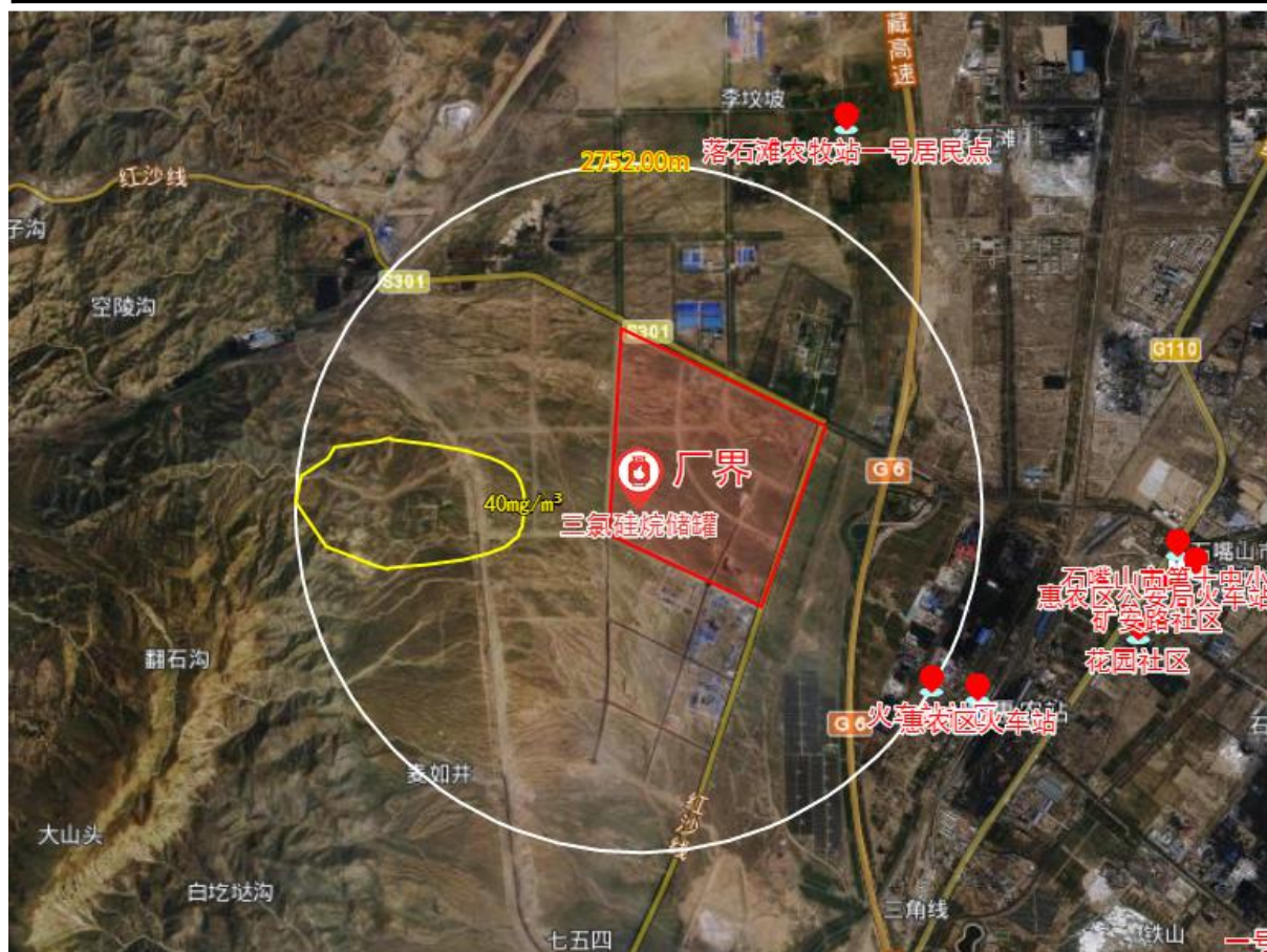
图 7.6-4 三氯氢硅储罐火灾次生 Cl 2 最不利气象条件预测毒性终点浓度范围图
